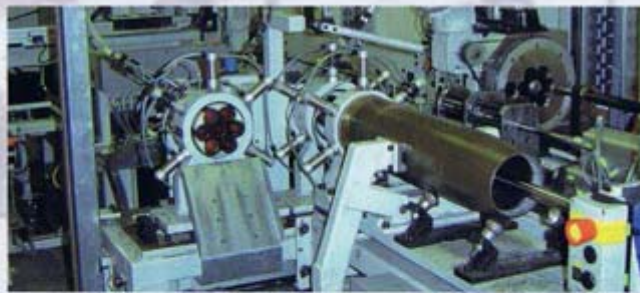
155mm-Granate in der Delaborierungseinrichtung der Nammo Buck GmbH in Pinnow.
